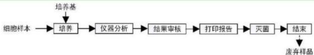
图 2-6 临床微生物检验检测工艺流程及产污环节
