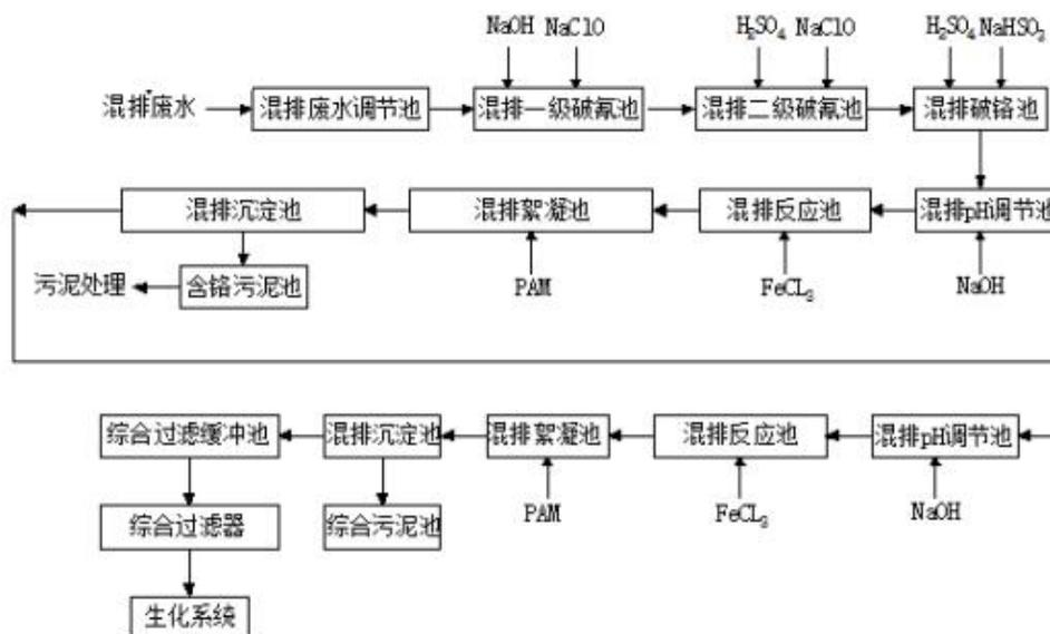
图 7.1-8 混排废水预处理工艺流程图
