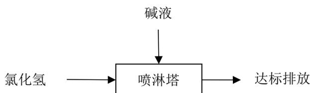
图7.3-1 一般酸碱废气处理工艺流程
