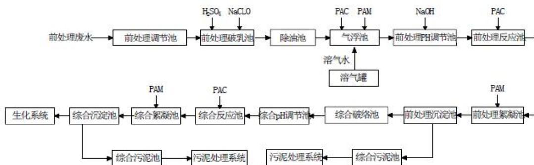
图 7.1-1 前处理废水预处理工艺流程图
