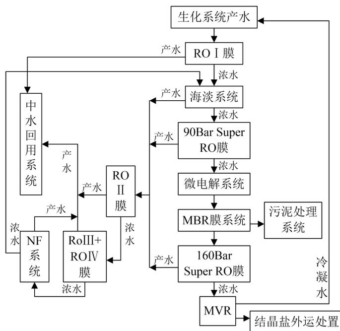
图 7.1-11 膜浓回用处理工艺流程图
