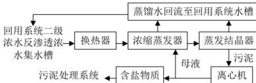
图 7.1-12 MVR 系统处理工艺流程图
