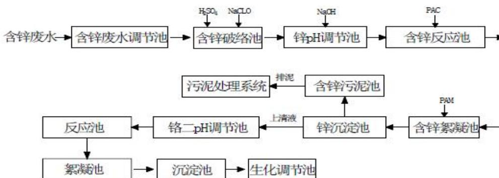
图 7.1-2 含锌废水预处理工艺流程图
