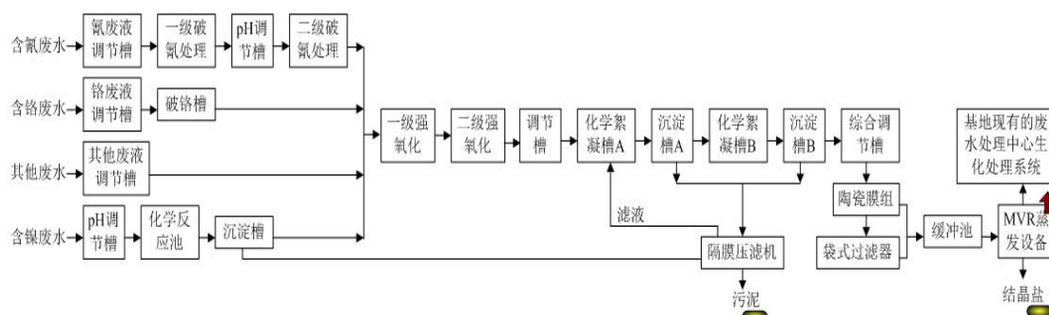
图 7.1-9 高浓废水预处理工艺流程图
