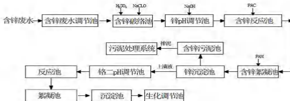
图 7.1-2 含锌废水预处理工艺流程图
