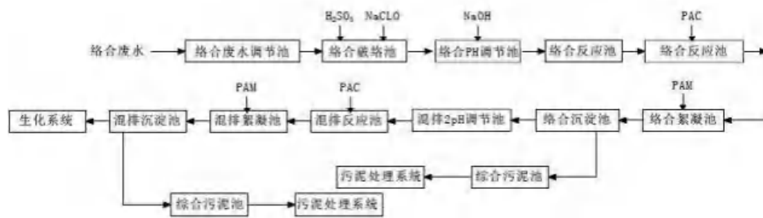
图 7.1-6 络合废水预处理工艺流程图
