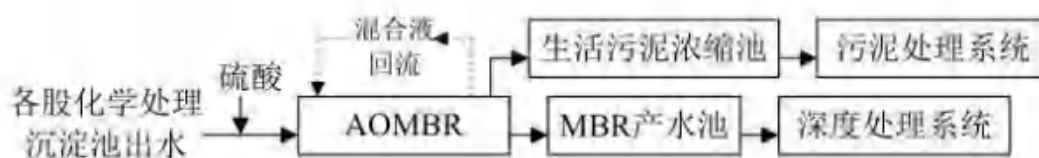
图 7.1-10 生化处理工艺流程图
