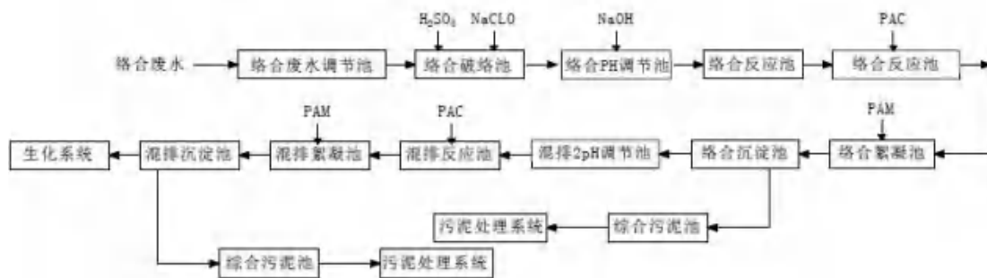
图 8.1-6 络合废水预处理工艺流程图
