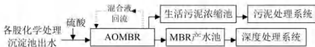
图 8.1-10 生化处理工艺流程图
