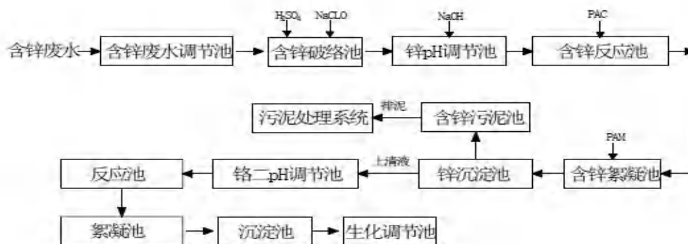
图 8.1-2 含锌废水预处理工艺流程图
